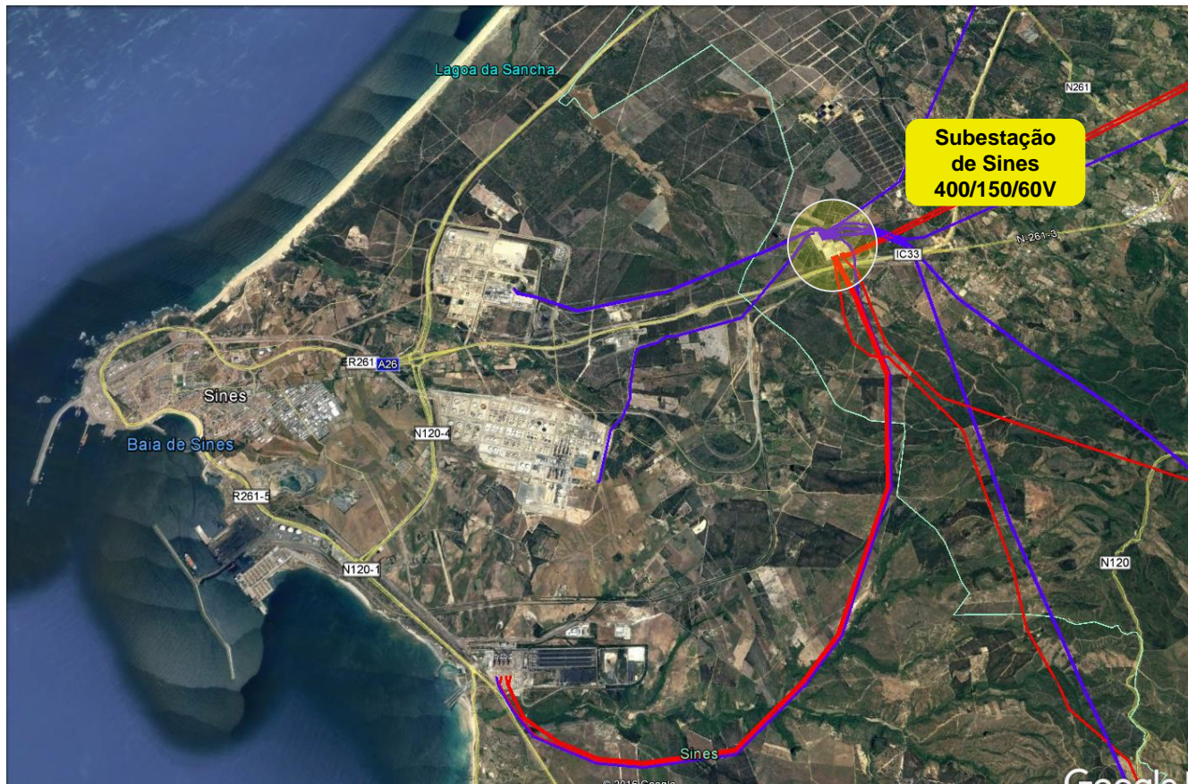
Representação da subestação de Sines e das linhas da RNT ligadas a esta instalação
